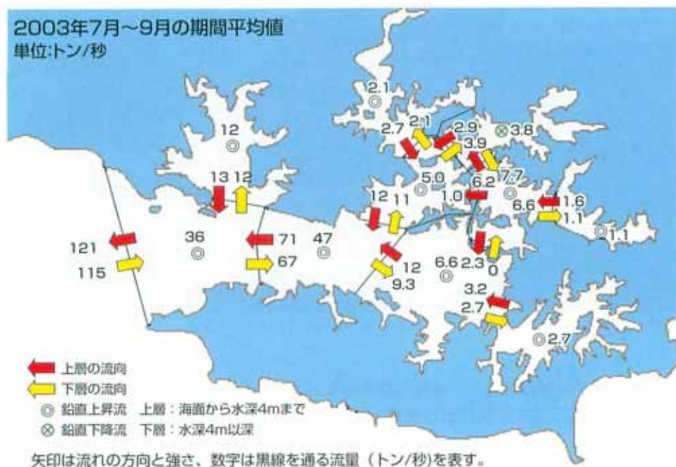
英虞湾の水質を考えるとき、湾全体の流れの方向や流量を知ることが必要です。上の図は、コンピューターを用いて英虞湾の夏の残差流を計算しました。36ページで述べた、水質と関係のあるのは残差流です。潮汐流が往復するだけなのに比べて、残差流は一定方向に流れるため、酸素など海水中に含まれる物質の移動に関する大切な流れです。上層の流れの向きが湾奥から湾口へ、下層の流れの向きが湾口から湾奥に向かっていることに注目してください。夏は湾内の水温が上昇し、また雨で塩分が低くなるために、湾内の水が湾外の水にくらべて軽くなります。地球の重力は軽い水を上層から湾外に押し出すようにはたらきます。そのために、図のような流れが生じます。
