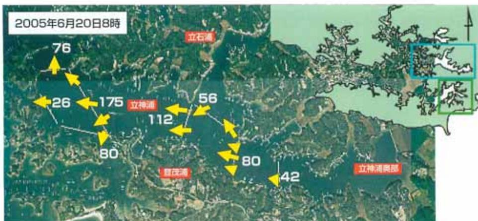
黄色い矢印は流れの方向と強さ、数字は白線を通る流量（トン/秒）を表す。
