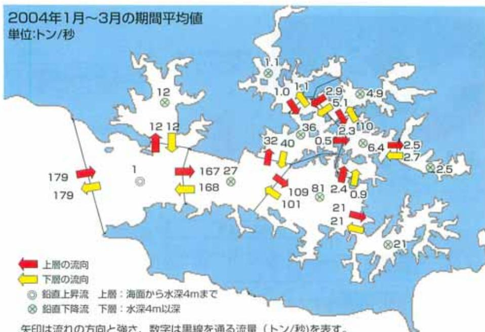
英虞湾の冬の流れは夏と正反対になります。つまり、上層の流れは湾口から湾奥へ向かい、下層の流れは湾奥から湾口へ向かいます。この流れの原因は冬に強くなる季節風（北西風）です。湾内の水と湾外の水の重さ（密度）に差がなくなるので、重力よりも風の影響が強くなるわけです。夏の残差流にも共通していますが、湾口と湾奥の流量の大きな違いに注目してください。湾奥の流量は湾口にくらべて大変小さいことがわかります。上層の流速で比較すると、湾口で2cm/秒（夏）、3cm/秒（冬）、湾奥の立神浦で0.8mm/秒（夏）、1.3mm/秒（冬）となり、湾奥の上層の流速は湾口の1/20以下であることになります。なお、これらは残差流の流速であることに注意してください。湾奥の残差流の流速が非常に小さいことは、湾奥に物質がたまりやすく、水質が悪化しやすいということを示しています。
