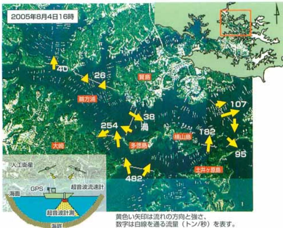
英虞湾奥部の潮汐流を実際に見てみましょう。図は賢島付近の上げ潮時の流れです。湾口からの流れは多徳島の南側で東西に分かれて、西側は鶴方浦へ、東側は横山島と土井ヶ原島の間の水路へ流れています。多徳島西側を抜けた流れの一部は、賢島南側で東向きを変えて神明浦方面に流れています。このように、多徳島南側で二手に分かれた流れが再び合流して神明浦と立神浦に流れ込むことが調査でわかりました。よく見ると、賢島南側に時計回りの渦が生じています。同じ水路でも南北で流れの方向が違うのです。賢島付近は湾の中でも流れが複雑な場所と言えるでしょう。
